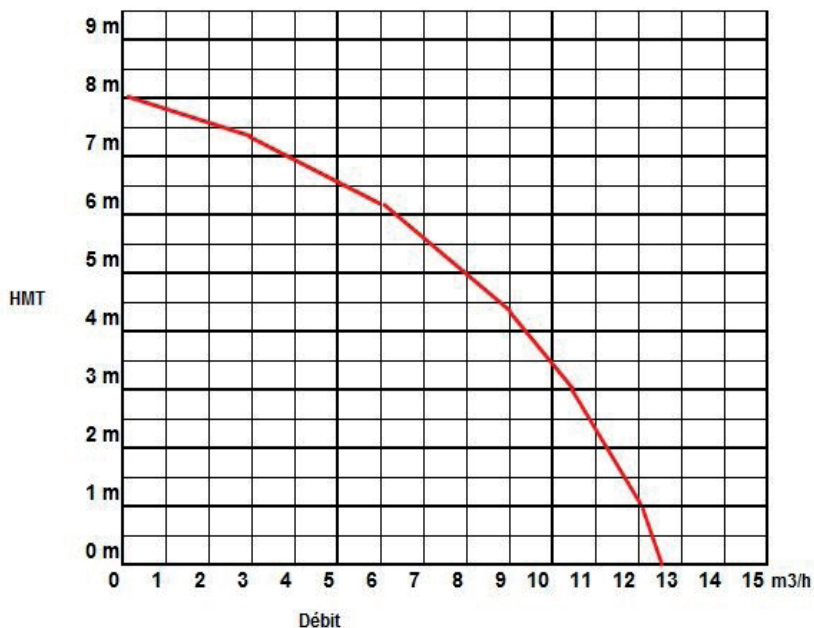
Courbe hydraulique de la pompe :
