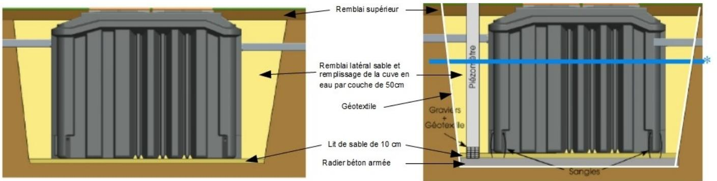
**Schéma de principe de pose BIOXYMOP6025/06/AC:**
