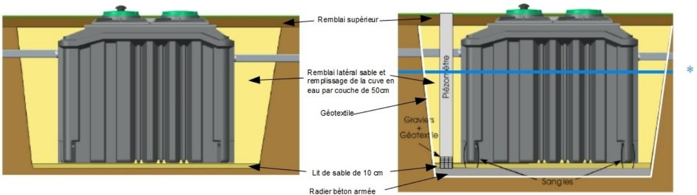
**Schéma de principe de pose des BIOXYMOP6030/09 et 12 :**
